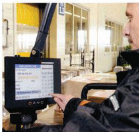
Die Stapler sind über ein Fahrzeugterminal und WLAN direkt mit dem WMS verbunden
