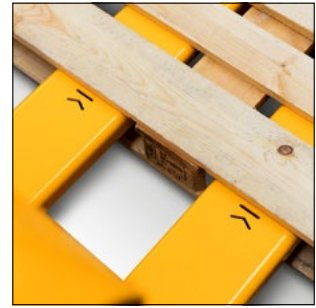
Einfahrhilfen und Gabelmarkierung
