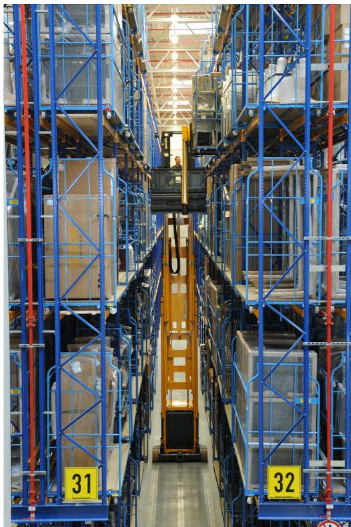
Die neun Gassen des Schmalganglagers werden durch einen Elektro-Kommissionier-Dreiseitenstapler EKX 515 bedient
