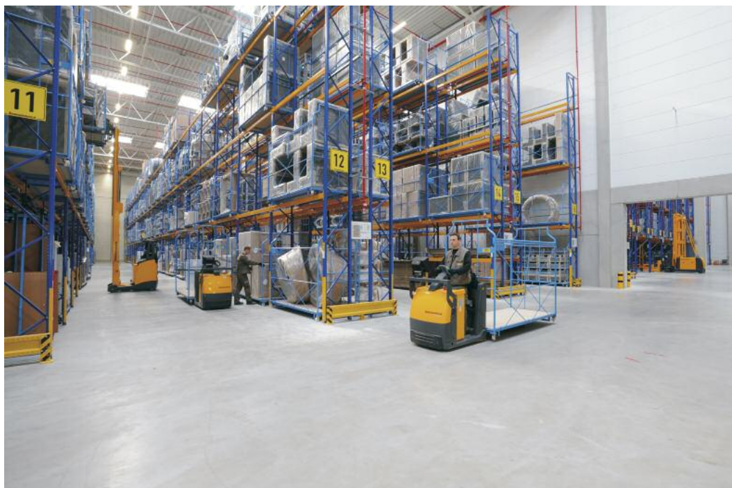
Im Logistikzentrum von Dedon hat Jungheinrich eine Lösung realisiert, die ein Warehouse-Management-System, WLAN-Funkanlage und Flurförderzeuge mit Fahrzeugcomputern umfasst
